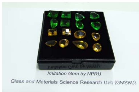
ภาพที่ 6 ชิ้นงานแก้วที่เจียรไนของแก้วที่เติมโครเมียม (III) ออกไซด์ (สีเขียว) และไอร์ออน (III) ออกไซด์ (สีเขียวอมเหลือง)
