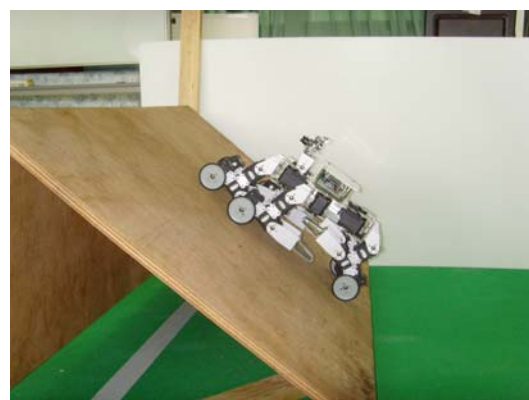
ภาพที่ 9 การเคลื่อนที่ของหุ่นยนต์ SWU โดยใช้ล้อในการเคลื่อนที่บนพื้นเอียง
