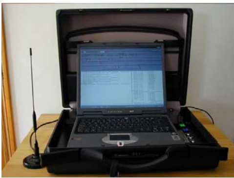
ภาพที่ 1 เครื่องมือสำหรับดักสัญญาณ โทรศัพท์ ที่มา (secret santa, 2555)
