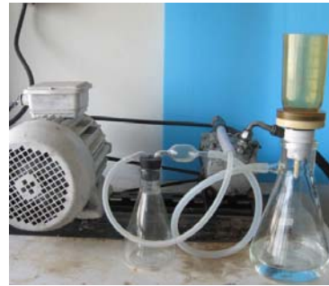
ภาพที่ 1 ปั๊มสุญญากาศที่ดัดแปลงจากคอมเพรสเซอร์ของแอร์รถยนต์
