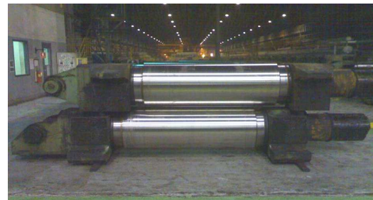
ภาพที่ 7 ลูกรีด สำหรับใส่ในแท่นรีดเหล็ก ที่มา: ภาพถ่ายโดย ทินกร แก่นทอง และคณะ, 2556
