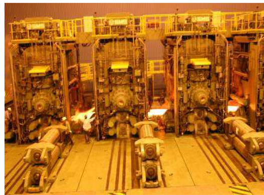
ภาพที่ 3 การรีดเหล็กแผ่นรีดร้อนอย่างต่อเนื่องที่แท่นรีด ที่มา: ภาพถ่ายโดย ทินกร แก่นทอง และคณะ, 2556
