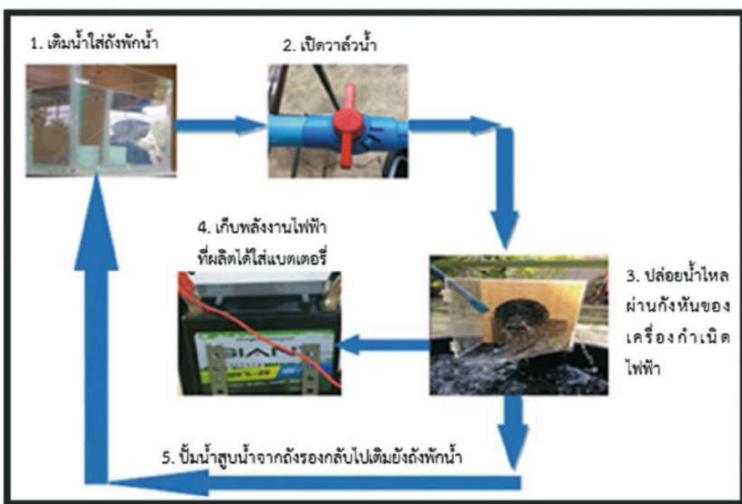
ภาพที่ 4 การทำงานของชุดทดสอบกังหันสำหรับระบบผลิตไฟฟ้าพลังงานน้ำ
