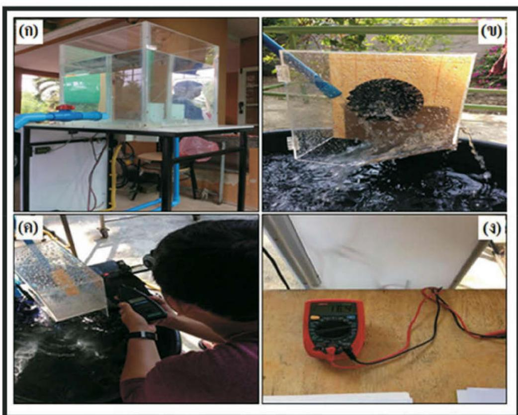
ภาพที่ 5 การทดสอบชุดทดสอบกังหันสำหรับระบบผลิตไฟฟ้าพลังงานน้ำ
