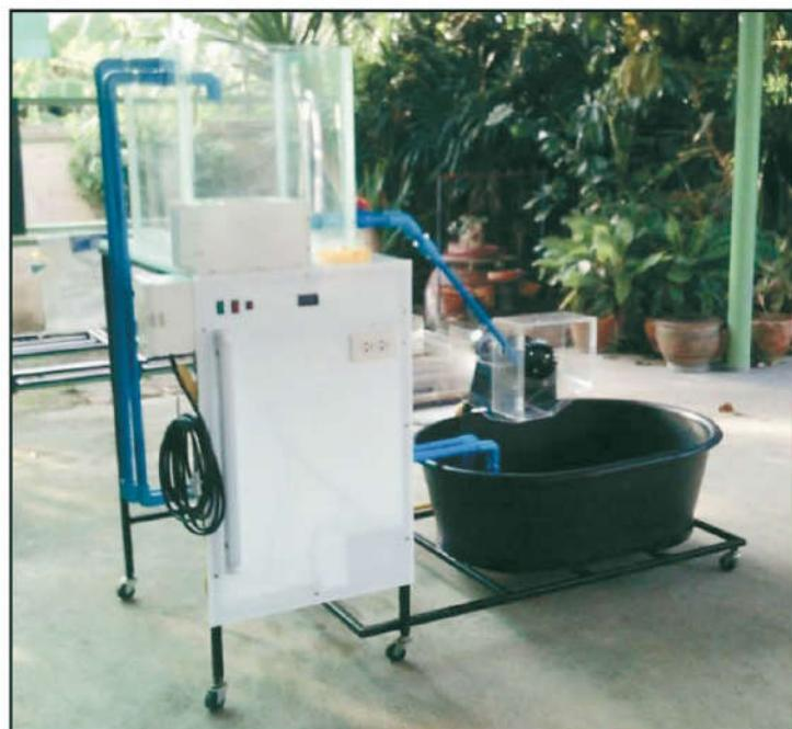
ภาพที่ 2 แบบจำลองระบบผลิตไฟฟ้าพลังงานน้ำ
