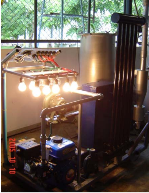
ภาพที่ 1. ระบบเครื่องก๊าซซิไฟเออร์และ เครื่องยนต์ขนาดเล็กที่ใช้ผลิตไฟฟ้า
