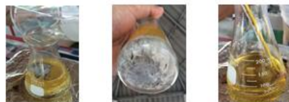
(ง) ล้างด้วย ชี้เถ้า 1 g (จ) ลักษณะสาร ขณะทำการล้าง (ฉ) ไบโอดีเซลที่ได้ จากการล้างด้วย
