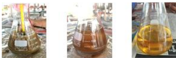
(ก) ลักษณะสาร ขณะทำปฏิกิริยา (ข) ลักษณะสาร ขณะแยกชั้น (ค) ไบโอดีเซล
