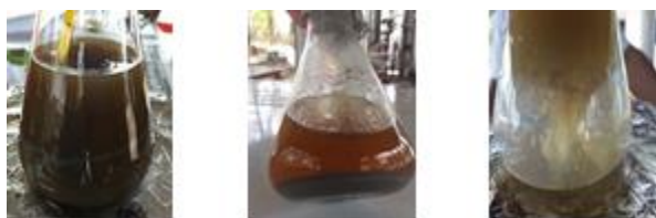
(ก) ลักษณะสาร ขณะทำปฏิกิริยา (ข) ลักษณะสาร ขณะแยกชั้น (ค) กระบวนการ การล้าง
