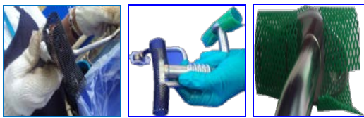
ภาพที่ 5. การนำแผ่นพลาสติก พีวี ซี มาปรับใช้เป็นตัวห่อหน้าแปลน
