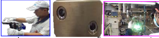
ภาพที่ 4. การปรับปรุง Jig ตัดชิ้นงานก่อนการเชื่อม ประกอบ
