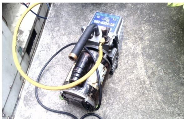
รูปที่ 1 เครื่อง Vacuum ระบบสารทำความเย็น
