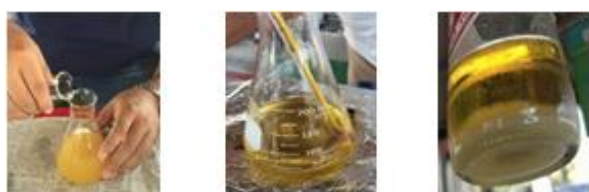
(ก) ลักษณะสารขณะทำปฏิกิริยา (ข) ลักษณะสารขณะแยกชั้น (ค) การแยกชั้นระหว่างไบโอดีเซลกับกลีเซอริน
